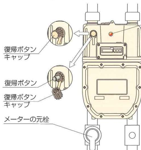
ガスが止まって、赤ランプが点滅していたら、復帰の手順にしたがって、操作してください。
